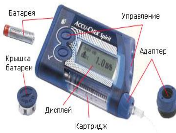
Рисунок 1. Устройство инсулиновой помпы
