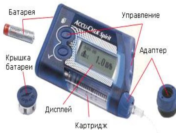
Рисунок 1. Устройство инсулиновой помпы
