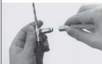
Соедините световод с эндоскопом (четверть оборота винта с рифленной головкой на резьбовой цоколь).
