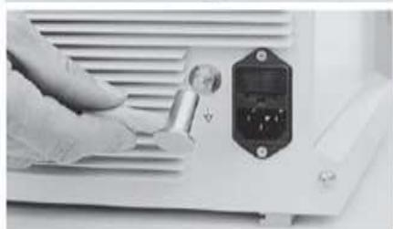
Прибор оснащен штекерным приспособлением 3 для выравнивания потенциалов.
