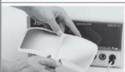
К прибору AUTOCON® 200 могут подсоединяться как монополярные, так и биполярные нейтральные электроды. При правильном подсоединении контрольная лампочка 11 рядом с гнездом подсоединения светится зеленым светом; если контрольная лампочка не светится, то имеет место неправильное подсоединение.
