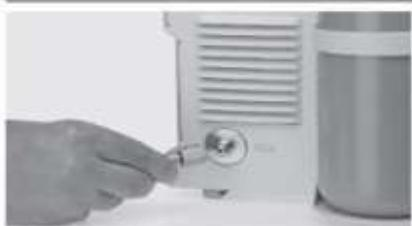
Установить баллон CO<sub>2</sub> вертикально в держатель, и закрепить запорным рычагом. Подсоединить выходной штуцер баллона CO<sub>2</sub> с помощью трубки высокого давления к газовому разьему прибора 17.
