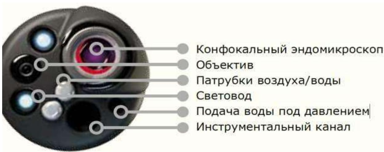
Рисунок 2.39 – Дистальный конец конфокального эндоскопа эндомикроскопической системы
