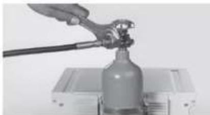
**1 вариант соединения.** Установить трубку адаптера на выходное отверстие CO<sub>2</sub> газового баллона и закрутить универсальным ключом
