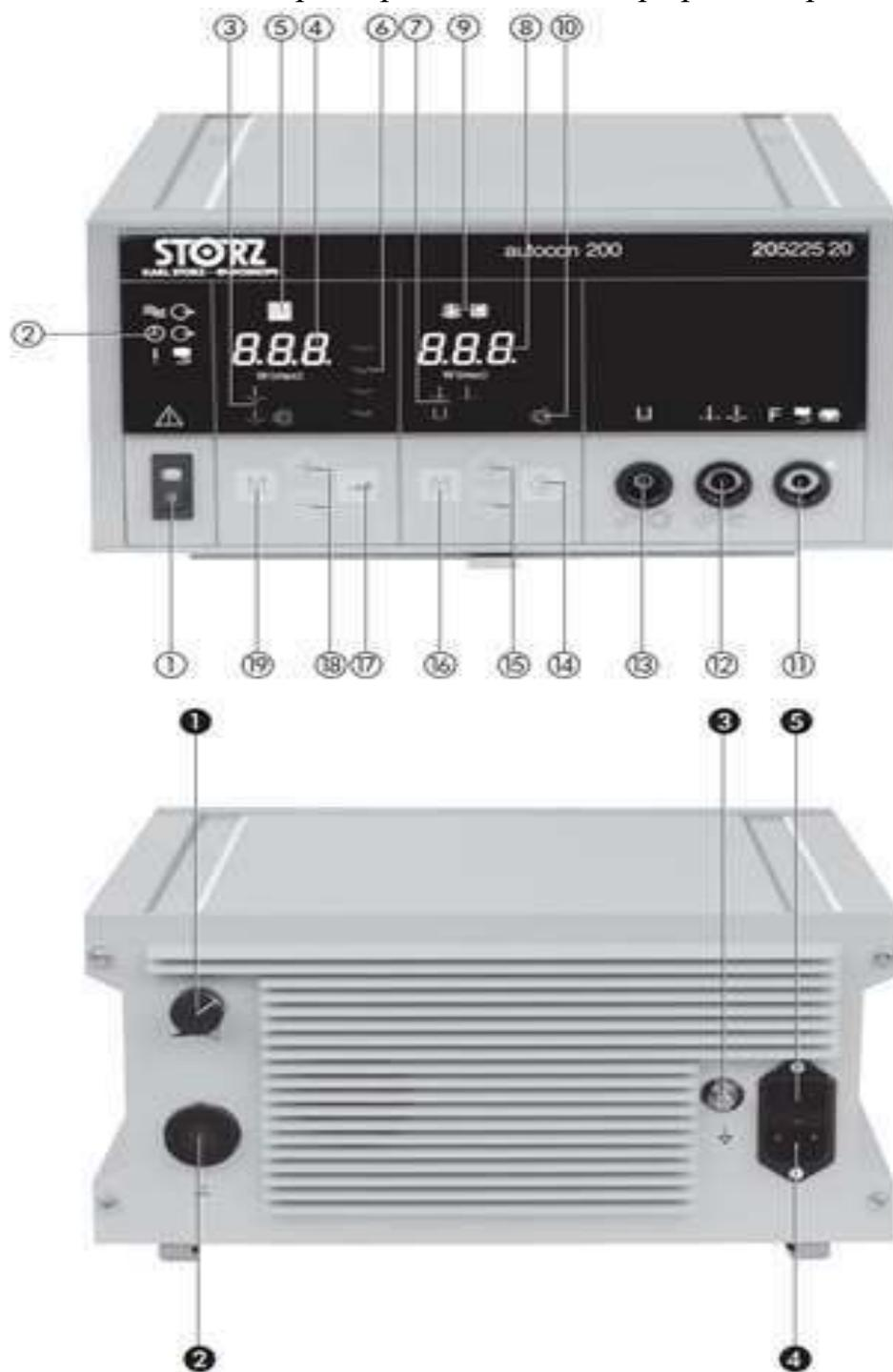
Рисунок 2.59 – Лицевая и обратная стороны высокочастотного хирургического прибора Задняя стенка прибора:
