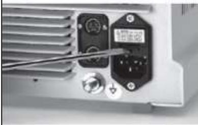
Освободить держатель 17 сетевого предохранителя подходящим для этого инструментом.
