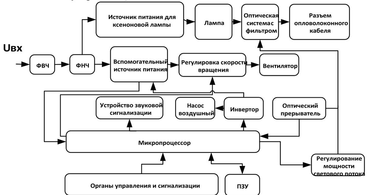
Рисунок 2.55 – Структурная схема источника холодного света
