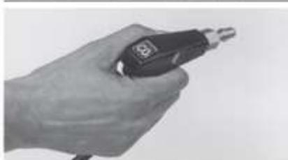
Газовый разъем 17 прибора подсоединить с помощью трубки адаптера непосредственно к настенному разьему центрального газоснабжения 3.3 – 7 бар.
