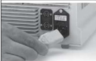
Подсоедините сетевой кабель, вставив штекер до упора в гнездо подключения
