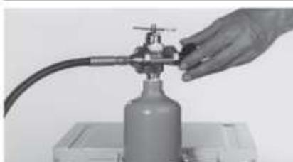
**2 вариант соединения.** Насадить штуцер трубки адаптера на CO<sub>2</sub> газового баллона и плотно закрутить
