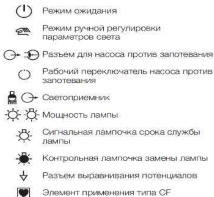
Рисунок 2.54 - Условные обозначения на лицевой панели прибора
