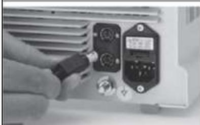
Оттяните назад защитное приспособление штекера SCB и вставьте штекер в одно из гнезд 14 SCB. Другой конец кабеля соедините с управляющим устройством KARL STORZ или другими устройствами SCB
