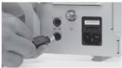
Оттянув назад защитное приспособление штекера SBC, вставьте штекер в одно из гнезд SBC. Другой конец кабеля соединяется с управляющим устройством.
