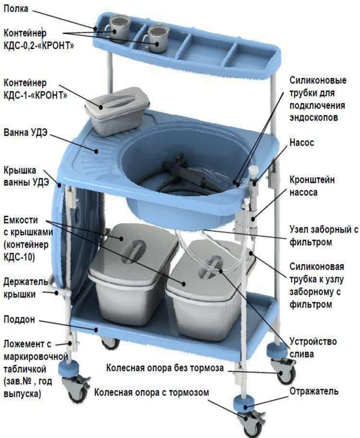
Рисунок 3.9 - Установка дезинфекционная эндоскопическая УДЭ-1-«КРОНТ»
