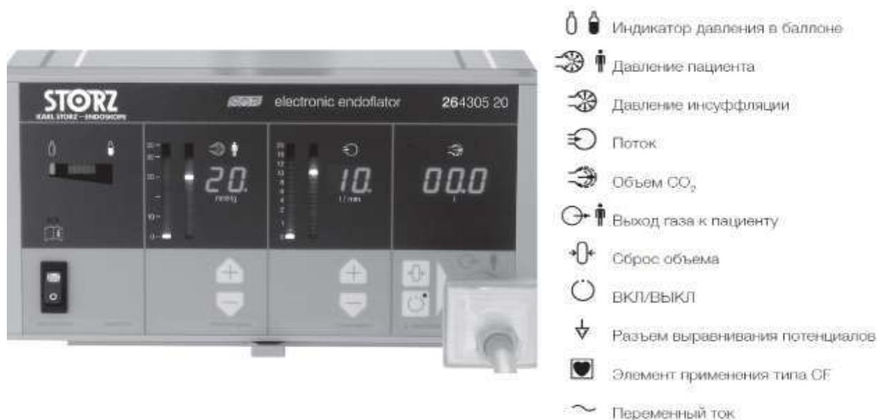
Рисунок 2.46 - Условные обозначения на лицевой панели инсuffлятора
