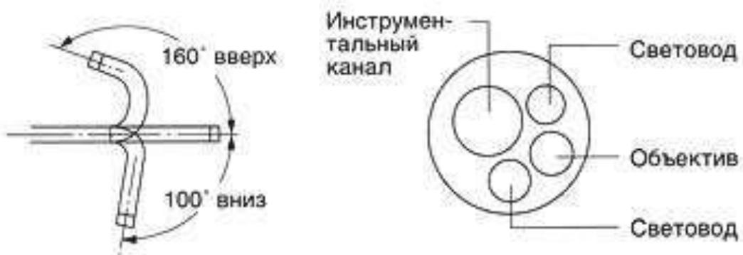
Рисунок 2.25 – Устройство дистальный конца и углы изгиба холедофиброскопа Olympus (Япония)
