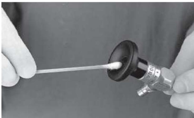
Рисунок 3.2 – Очистка оптических поверхностей
