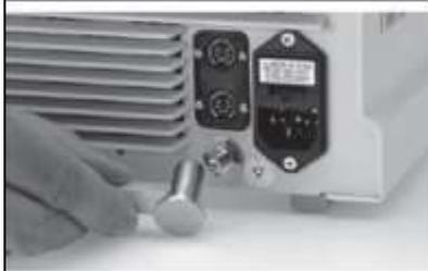
Прибор оснащен штекерным приспособлением 15 для выравнивания потенциалов.
