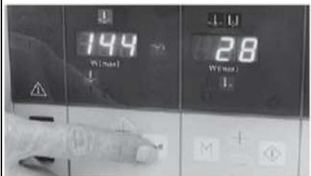
Установить при необходимости отличный от исходной установки коагуляционный эффект при разрезе. Для этого нажатием клавиши 17 предварительно выбрать одну из ступеней: 1 (минимальный коагуляционный эффект) до 4 (максимальный коагуляционный эффект). Выбранная ступень подсвечивается на индикаторной панели 6.
